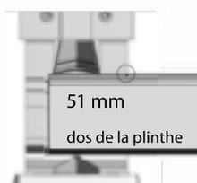
Placer ensuite la plinthe en ajustant le repère précisément sur l'arrêt de la surface de butée. Abaisser le levier pour gruger l'angle extérieur.
